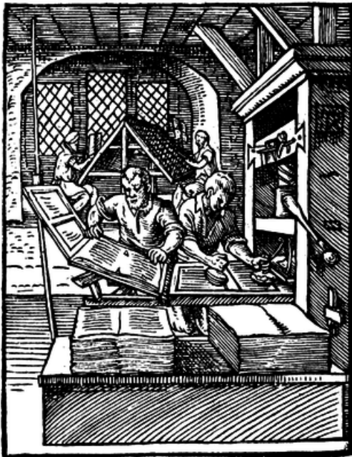
FIGURE 1.13. – Presse à imprimer vers 1568 ; 240 impressions par heure.
